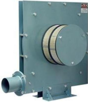
Soplador robusto y fiables, de presión constante. Estos ventiladores se utilizan para muchas aplicaciones industriales y comerciales que requieren aire a una presión específica y volumen. El diseño único de la unidad de una sola etapa incorpora un mínimo de mantenimiento de campo. Placas laterales y de desplazamiento son de acero, con pernos de sujeción para evitar fugas. Los impulsores de aluminio están conectados directamente proporcionando un funcionamiento suave y silencioso.
