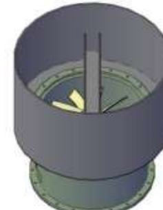
CON COMPUERTA DE MARIPOSA ABIERTA (FUNCIONANDO)
